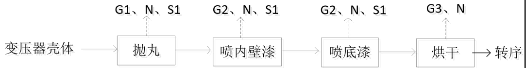
图2-3 表面处理抛丸喷漆工艺流程图（G-废气，S-固废，N-噪声）
