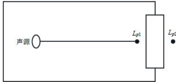
图 4-1 室内声源等效为室外声源图例
