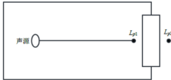
图 4-1 室内声源等效为室外声源图例
